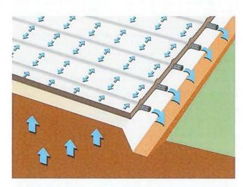
Le SOMTUBE FTB dans cette application de drainage sous dallage limite les sous pressions à des valeurs prédéterminées, sans dommage pour l'ouvrage. Il remplace le dispositif traditionnel en matériau granulaire drainant constitué de bas en haut par :
