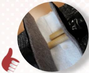
Connexion facile en recouvrant les géotextiles filtrant et drainant et en juxtaposant les mini-drains
